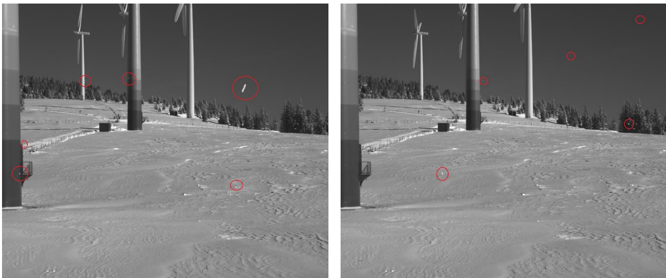
Abbildung 13: Beobachtung von Eisfall. Herabfallende Eisstücke sind im Kamerabild sichtbar (zur besseren Erkennbarkeit rot markiert).
