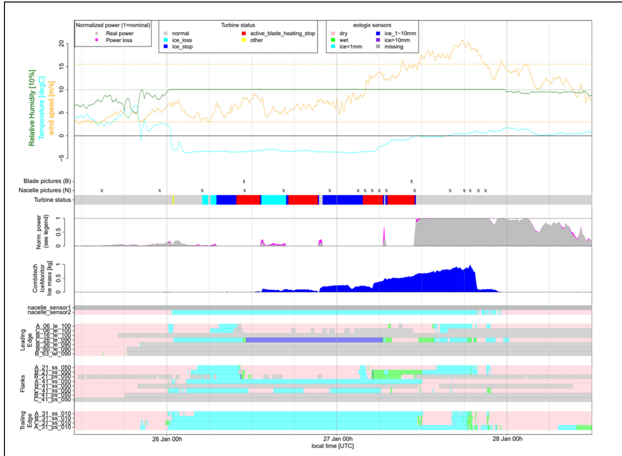
Abb. 8: Webcam-Aufnahmen und grafisch aggregierte Übersicht der Messdaten zum zeitlichen Verlauf eines Vereisungsereignisses an einem Standort in Deutschland
